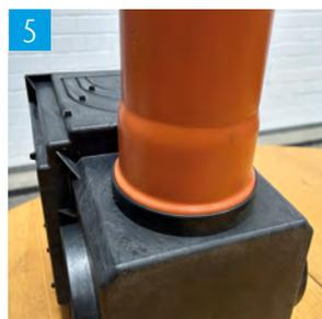
KG-Muffe zwischen dem mittleren und äußeren Ring mit ausreichend Druck platzieren. Ggf. Gleitmittel verwenden.
