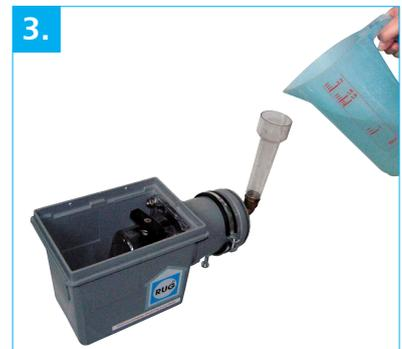
Die Wasserspiegelhöhe im Trichter ist 10 Minuten lang zu beobachten und ggfs. durch Nachfüllen auf der ursprünglichen Höhe zu halten. Der Rückstauverschluss gilt als ausreichend dicht, wenn in dieser Zeit nicht mehr als 0,5 l nachgefüllt werden müssen.
