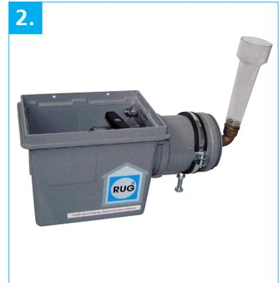
Rückstauaggregat mit Dichtung in Prüfvorrichtung einsetzen und mit beiden Muttern anschrauben, Notverschluss öffnen. Waagrecht stellen und Prüfvorrichtung bis zur Markierung mit Wasser auffüllen.
