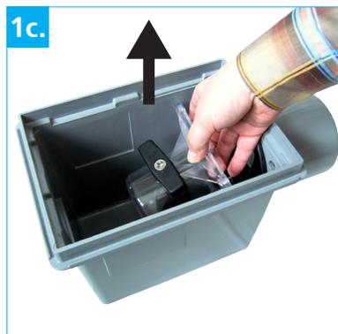
Nach der Entnahme des Schlammeimers beide Muttern am Rückstauaggregat lösen und Aggregat aus Kellerablauf ausbauen, reinigen, Dichtungen überprüfen und ggfs. erneuern.
